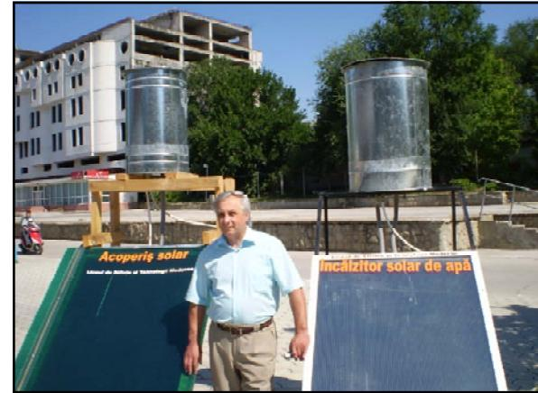
Încălzitorul conține un colector, executat în formă de panou din masă plastică, care include o secție transparentă și altă absorbantă de energie solară, despărțite între ele de o placă transparentă, în fiecare din ele fiind executate canale tubulare. La aceste canale sunt unite colectoare de alimentare cu apă rece și de evacuare a apei încălzite, iar sub secția absorbantă este amplasat un strat termoizolator.
