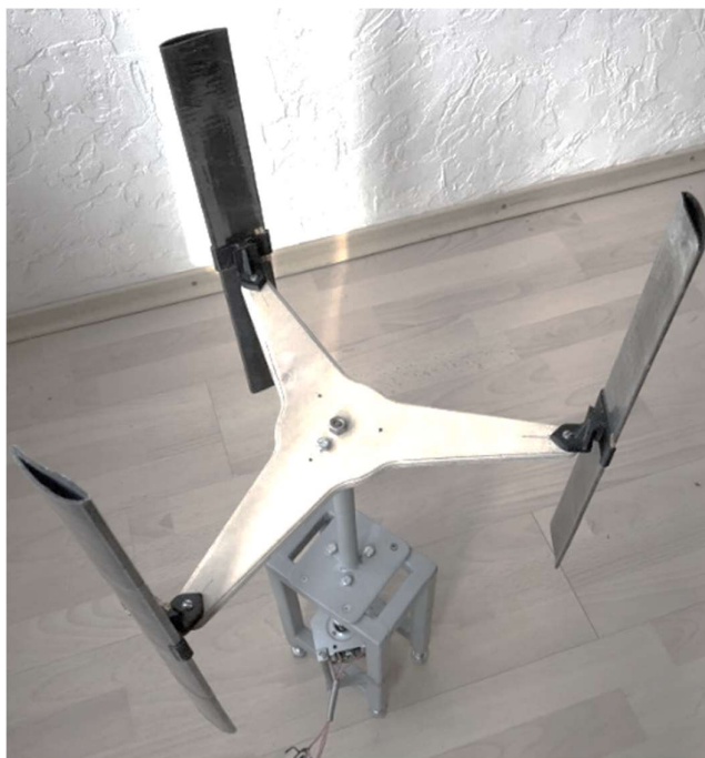
Fig. 2. Model turbină eoliană cu ax vertical cu pale cu profil aerodinamic asimetric fixate cu curbura în interior.
