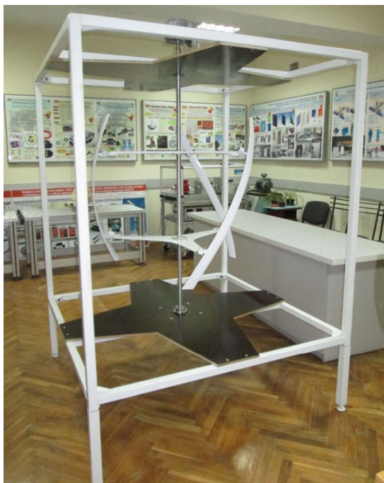
Fig. 1. Model turbină eoliană cu ax vertical cu pale elicoidale reglabile.
