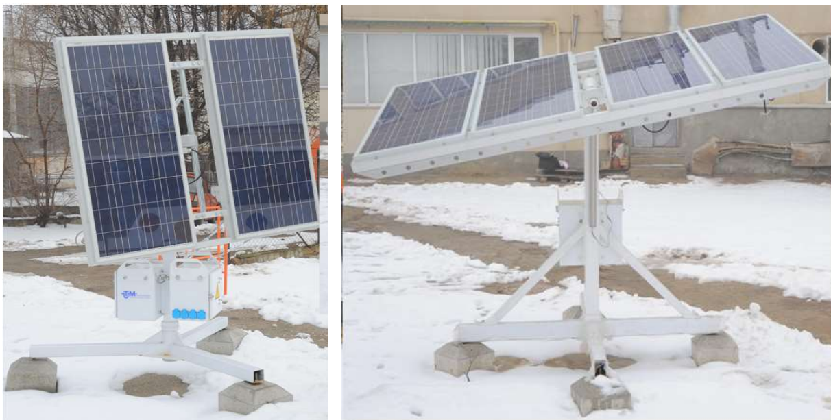
Fig. 2. Sisteme fotovoltaice cu autoorientare cu 2 și 4 panouri.
