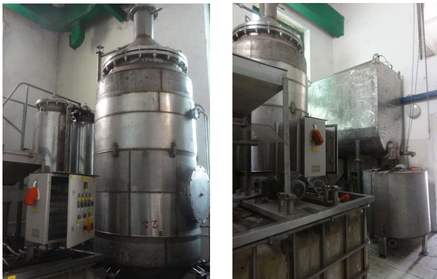
Bioreactor pilot și echipament tehnologic pentru testarea proceselor de fermentare anaerobă a biomasei în prezența fito-catalizatorilor (sediul uzina Alimentarmaș, Chișinău) elaborate de echipa USM
