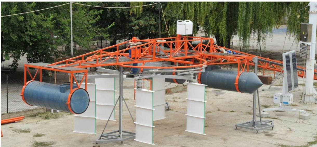
Fig. 5. Microhidrocentrală cu rotor hidrodinamic modificat: a – model computerizat; b – protip industrial.
