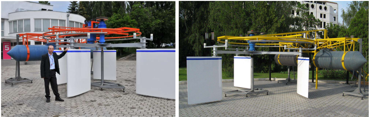
Fig. 4. Microhidrocentrală cu 5 și 3 pale hidrodinamice reglabile.
